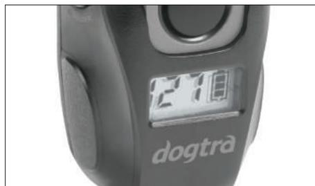
L'écran LCD affiche le niveau d'intensité (0 - 127). L'indicateur de charge de la batterie de l'émetteur affiche trois barres en état de charge complète, 2 barres en état de charge moyenne et 1 barre lorsqu'il faut recharger la batterie.
