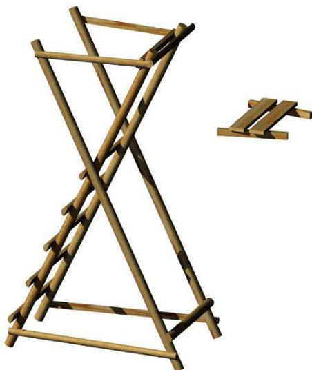
6. Alignez la structure en évitant toute distorsion latérale. Collez le support demi rondin de derrière (pos.5) sur les pieds rondins (pos.1) avec deux vis, une de chaque côté.
