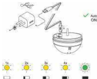
Lorsque vous connectez votre Deeper CHIRP+ à une source d'alimentation, il s'allume automatiquement. Un voyant orange clignote à intervalle régulier pour indiquer que l'appareil est en chargement. Le nombre de fois que celui-ci clignote indique l'état de la batterie.
