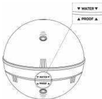
① Ne jamais mettre votre Deeper dans l'eau lorsqu'il est connecté à un câble de chargeur. Ceci pourrait endommager l'appareil et tout dommage ne sera pas couvert par la garantie. Assurez-vous toujours que la coque supérieure soit bien fermée et que les indicateurs « Water » et « Proof » soient parfaitement alignés avant de mettre votre sondeur Deeper dans l'eau.
