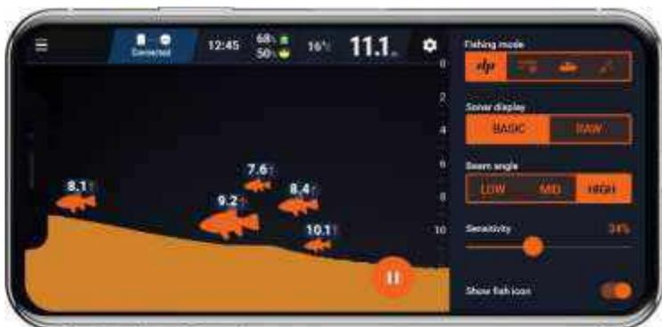
**Angle du faisceau** : permet de changer entre les différents angles de faisceau de votre sondeur Deeper.
