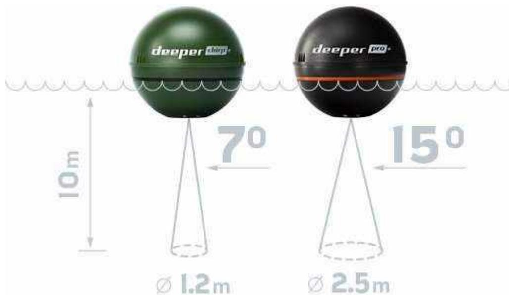
Veuillez-vous reporter au tableau de comparaison ci-dessous, qui indique le diamètre du fond recouvert par chaque faisceau (modèles Deeper PRO, PRO + et Start).
