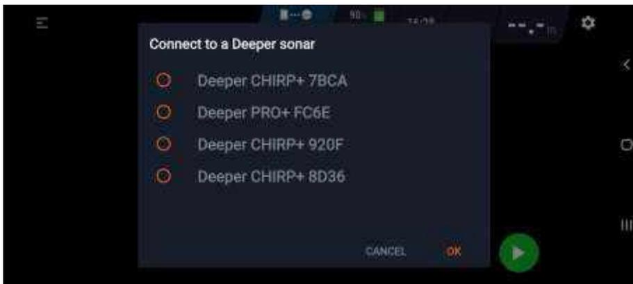
Appuyez sur ce bouton pour établir une connexion avec votre sondeur Deeper (votre sondeur Deeper doit être allumé : soit placé dans l'eau, soit connecté à un chargeur).
