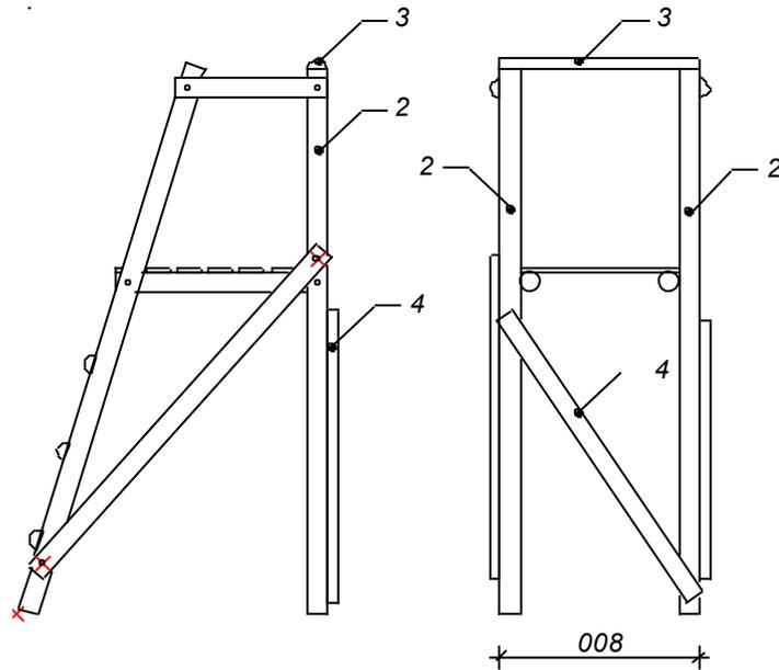
7. Fixez l'arrêt barrage L=800 (pos.3) sur les pieds de derrière (pos.2) avec deux vis, une de chaque côté.
