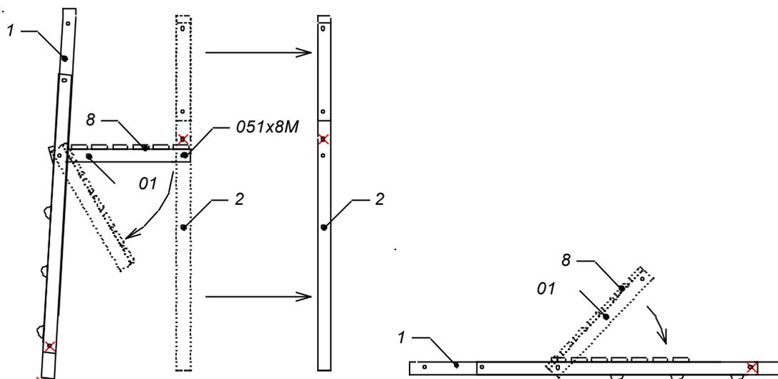
Enlever les boulons du plancher (pos.8) sur le côté des pieds de derrière (pos.2);
