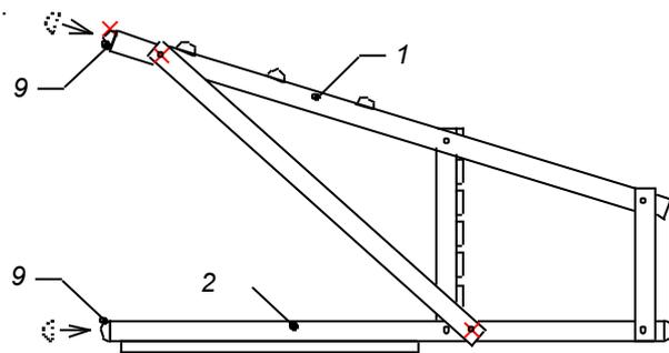
9. Soulevez le mirador, serrez tous les boulons de fixation au jusqu'au craquement caractéristique du bois. La construction est assemblée.
