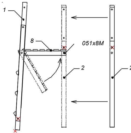
Mettez les boulons de fixation M8x150 dans les trous des supports de plancher (pos.10).
