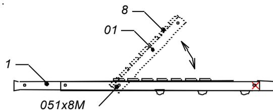
Mettez les rondelles et les écrous sur les boulons dans les trous percés, sans complètement visser l'écrou.
