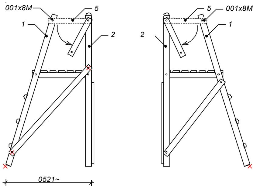
Tourner des arrêt-barrages latéraux (2 pièces) (pos.5) vers les pieds de derrière
