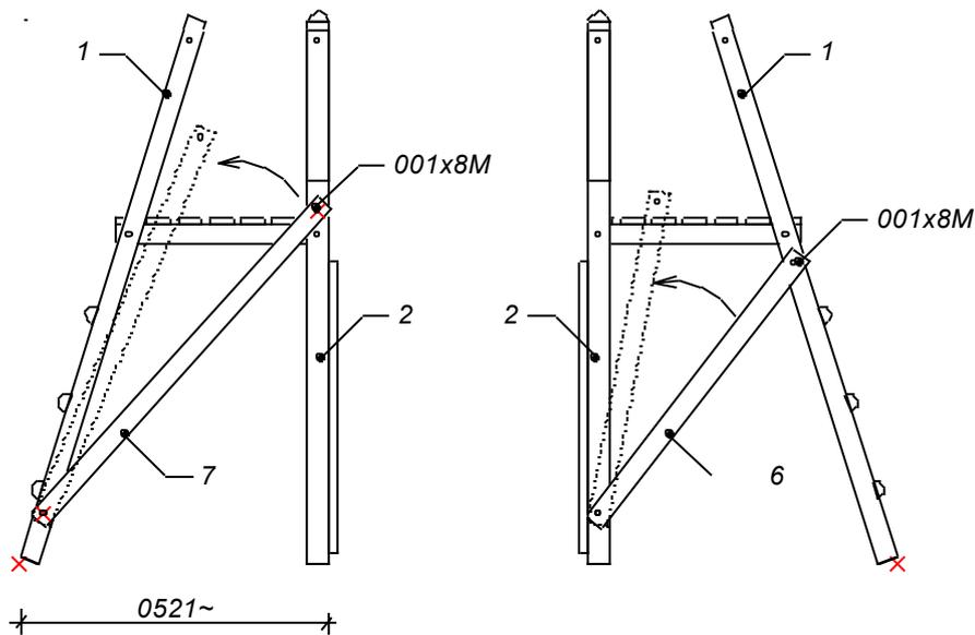
Enlever les boulons du support latéral en demi- rondin (pos.7) du côté des pieds de derrière (pos.2);
